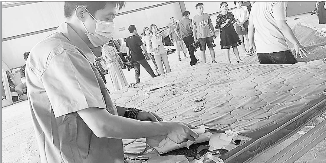
济南西部大件垃圾资源化处置中心工作人员正在拆解床垫。
